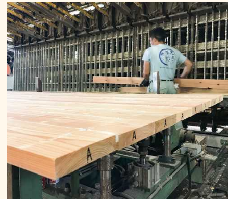
■接着が固まったら厚みを削り仕上げます。
